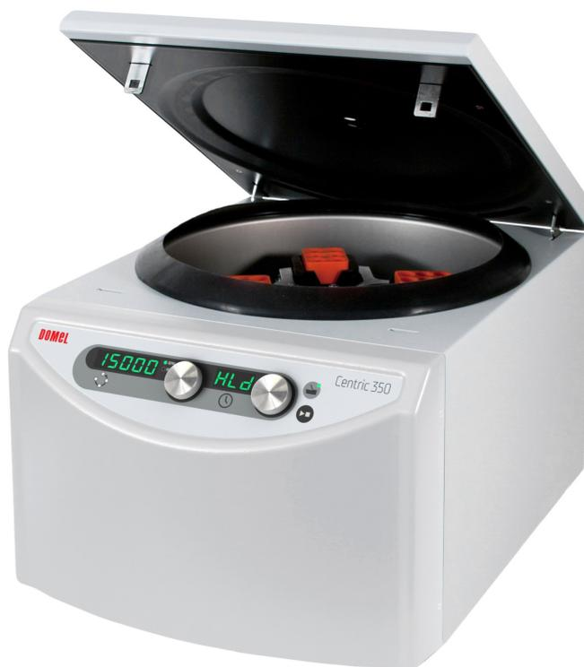
**Centrífuga CENTRIC 350 / CENTRIC 350 IVD** es una centrífuga de laboratorio universal, diseñada para su uso en laboratorios médicos, industriales y científicos para separar sustancias con diferentes densidades relativas por fuerza centrífuga.
