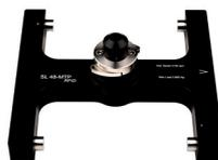
Rotor oscilante de dos lugares para placas MT con portadores de placas
